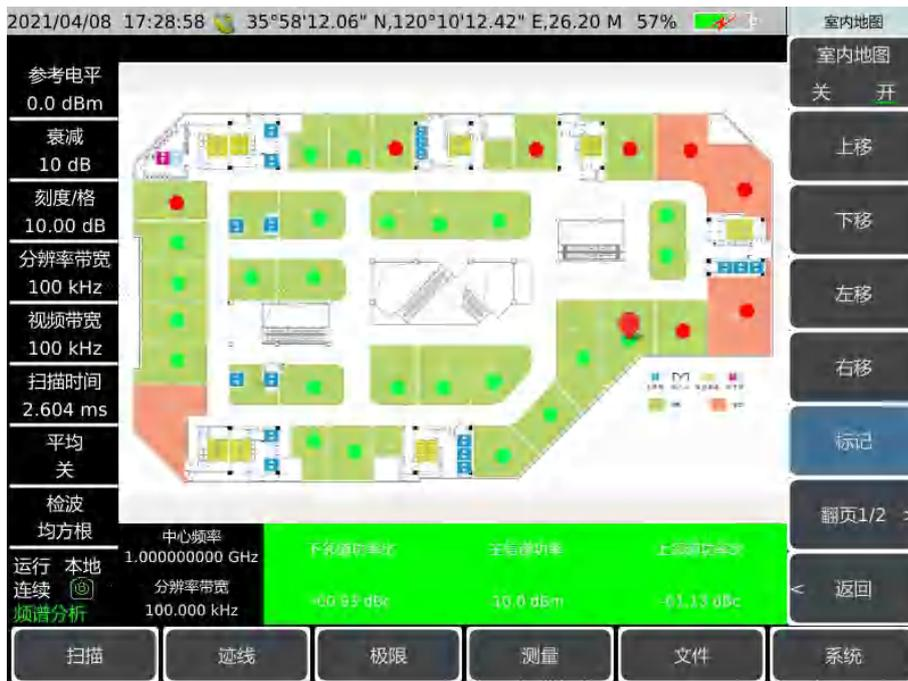
图 5-29 室内地图邻道功率比测量图
