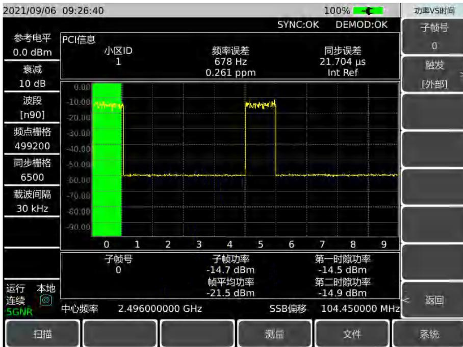
图 11-8 功率 VS 时间显示界面
