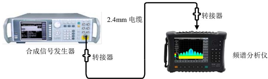
图 5-1 信号发生器与频谱分析仪的连接示意图
