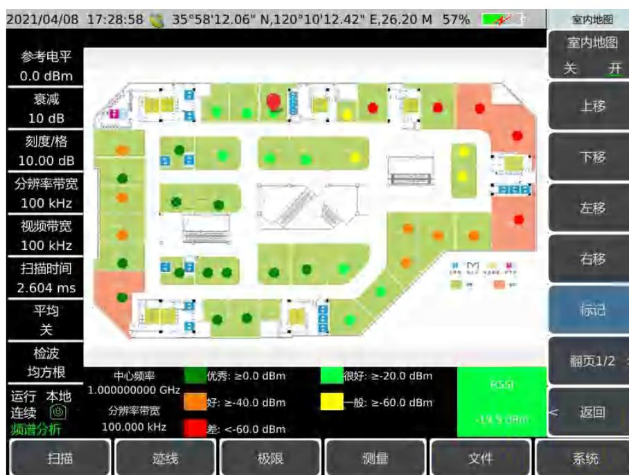
图 5-28 室内地图 RSSI 测量图
