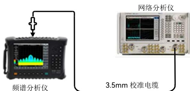
图 12-19 输入端口电压驻波比测试
