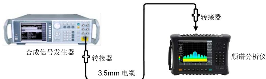
图 12-4 频率读出准确度测试框图
