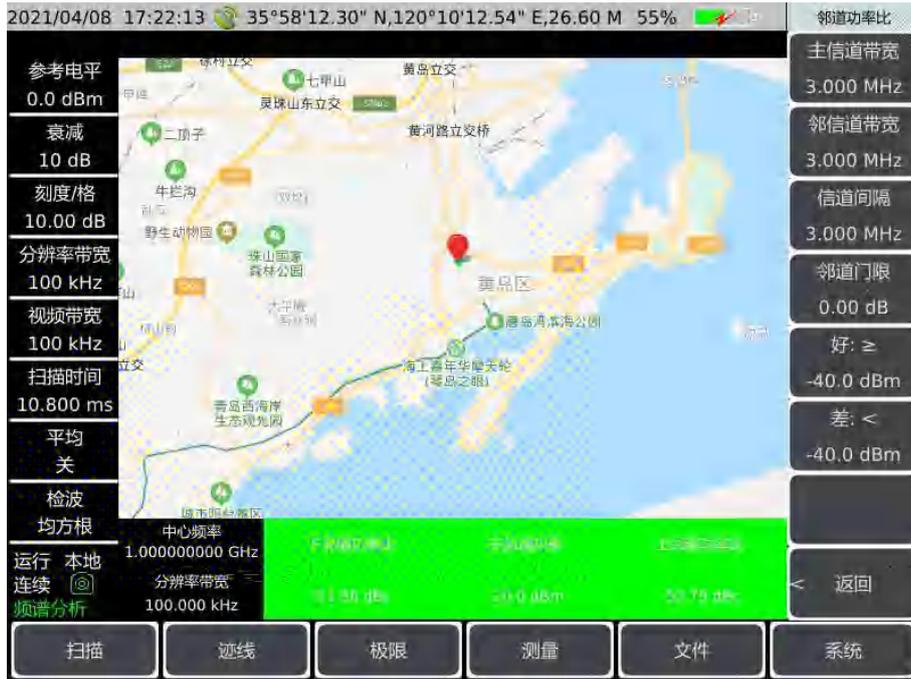
图 5-27 室外地图邻道功率比测量
