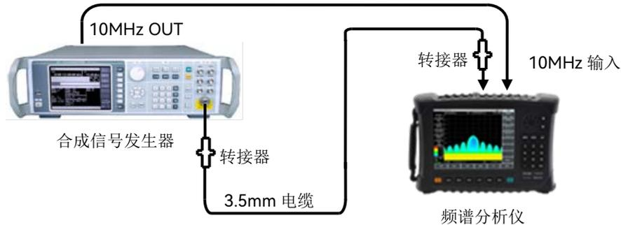
图 12-8 分辨率带宽转换不确定度测试设置
