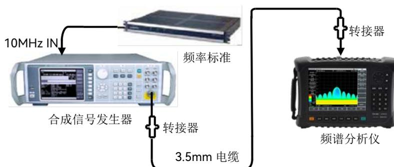
图 12-2 频率参考准确度测试
