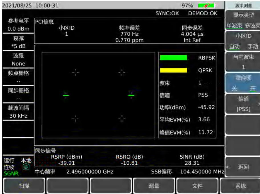
图 11-5 单波束测量星座图界面
